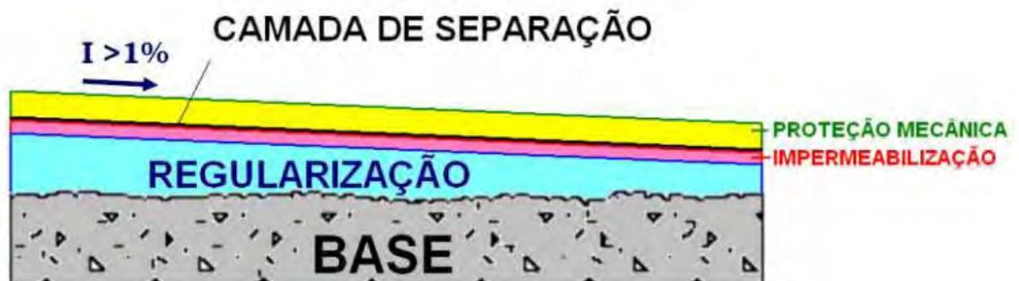
Figura 7 - Camada de Separação. Fonte : Slides, PUC GOIÁS
