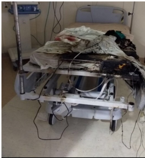
Figura 40: Acidente com bisturi elétrico durante realização de uma traqueostomia numa unidade de UTI.
